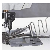
QB包边机构 QB wrapping construction
